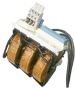
内置交流电抗器（标配）用于输入保护
